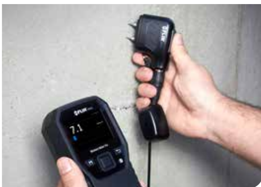
Sonda con clavija externa para lecturas de humedad resistivas.
